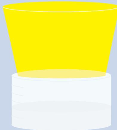
Calcula la superficie del embudo, puesto que la lluvia caída ha sido interceptada por dicha superficie. Después mide los cm. de agua que se han recogido en el frasco pequeño. El volumen de agua, será la cantidad de lluvia por unidad de superficie. Calcula a diario la cantidad de precipitación que se recoge en un lugar próximo a tu clase.
